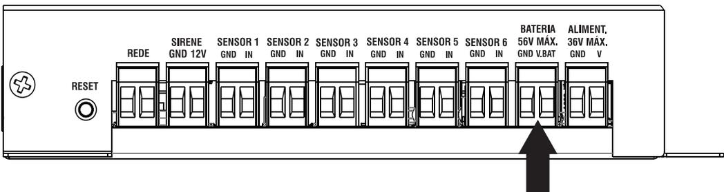
O conector **BATERIA** é utilizado para o monitoramento da tensão do banco de baterias, possibilitando ao usuário a leitura da tensão em tempo real, tendo total controle da energia das baterias no local. Além de possibilitar o acionamento das saídas Rele baseado na tensão do banco de baterias configurada via interface web, acionando por exemplo um gerador.
