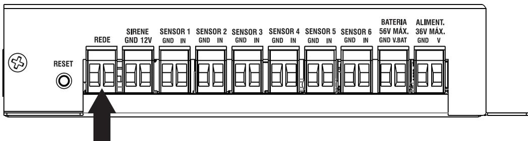
Este conector tem a finalidade de monitorar o status da rede da concessionária de energia (OK/FALHA). Conecte um cabo de duas vias com **Fase-Neutro** ou **Fase-Fase** diretamente ao conector Borne "REDE". Cuidado ao realizar esta conexão. Aconselhamos no momento da instalação que a rede da concessionária de energia esteja desligada para evitar acidentes.
