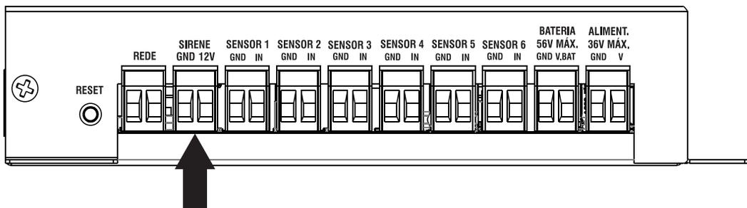
Possui uma saída para conexão de sirene piezoelétrica fornecendo 12V/300mA. A saída sirene pode ser configurada, tendo a possibilidade de habilitar seu funcionamento quando determinado Sensor/Zona(1) for acionado.
