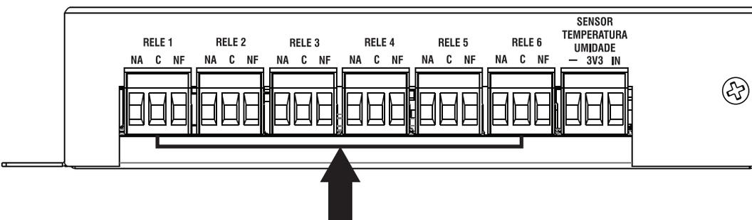
Possui seis (06) saídas Relé que podem ser utilizadas como normalmente aberta (NA) ou normalmente fechada (NF), podendo ser configurada para alterar o estado do relé baseado na leitura da entrada dos sensores, temperatura externa, tensão do banco de baterias, falta de rede elétrica ou manualmente através da interface web.
