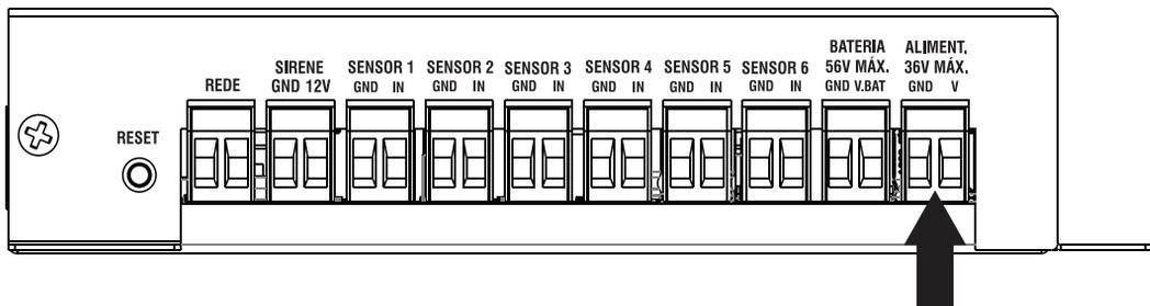
O conector **ALIMENT.** é utilizado para a conexão da fonte de alimentação da Central de Monitoramento Gerenciável. Devem ser utilizadas fontes de tensão contínua (DC) de 12V a 36V e no mínimo 1A. Para que a Central tenha maior eficiência é aconselhada a utilização de uma fonte nobreak exclusiva para sua alimentação, evitando possível falha no monitoramento.
