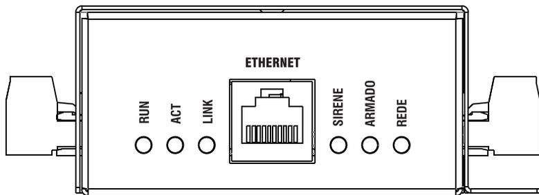
Quando alimentado o LED “**RUN**” pisca indicando que a Central de Monitoramento Gerenciável está em operação, e pronta para ser acessada via interface ethernet.
