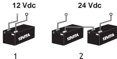
Para o modelo de MINI MAX 13,8V utilizar o exemplo 1 de banco de bateria. Para o modelo de MINI MAX 27,5V utilizar o exemplo 2 de associação de baterias.
