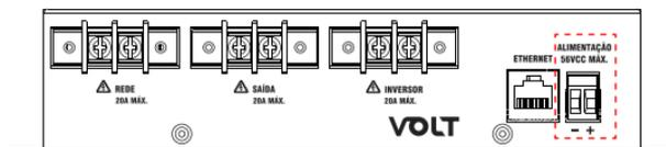
**2º passo:** Conecte um cabo patch cord na porta **ETHERNET** da ATS a uma porta **LAN** do seu roteador. A ATS por padrão de fábrica é enviada com as configurações de rede com o **DHCP habilitado**.
