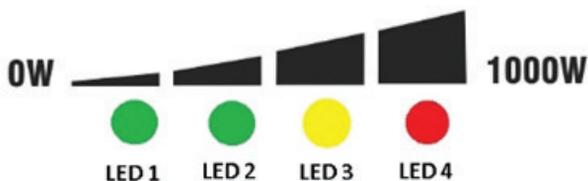
**LED 1 Piscando** - Indica que o Inversor Senoidal está operando com potência entre **0% e 25%** de sua capacidade.
